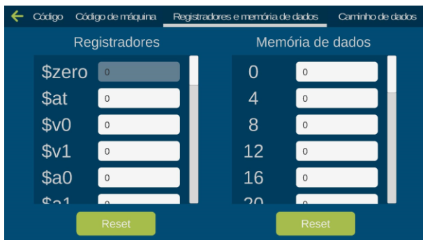
Figura 11. Tela para visualizar/alterar os valores da memória de dados e dos registradores.
