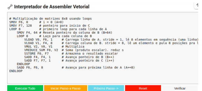
Figura 8. Visualização da execução de um assembly vetorial com registradores e memória para multiplicação de matrizes com laços aninhados em O(n^2) .
