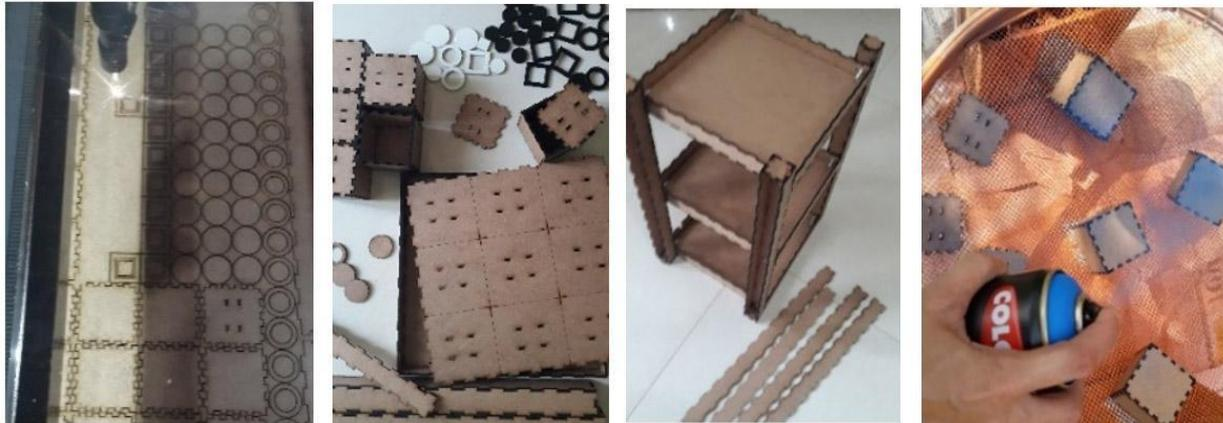
Figura 8: Construção das partes físicas do *Hash 3D*
