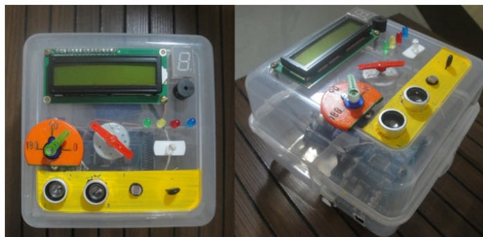
Figura 6: A "caixinha mágica" contendo os seguintes componentes: 1 display LCD, um display de 7 segmentos, 1 buzzer, 1 servo motor, 1 motor DC, 4 LEDs, 1 LED RGB, 1 sensor de distância, 1 sensor de luz e 1 sensor de temperatura.
