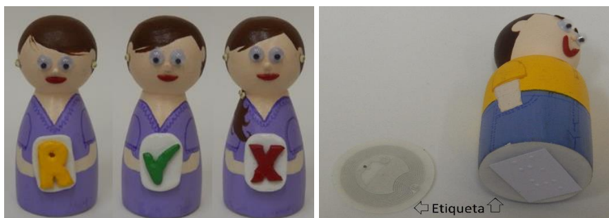
Figura 13. À esquerda, bonecos para gerenciar a escolha dos estados afetivos no TangiSAM . À direita, Etiquetas RFID posicionadas na parte inferior de cada boneco do TangiSAM .
