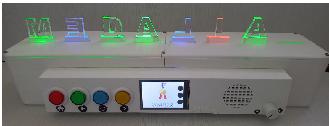
Figura 2: Nova versão do Alfabá : tela ampliada, botões redesenhados e estrutura reforçada, desenvolvida a partir de observações em teste de usabilidade.
