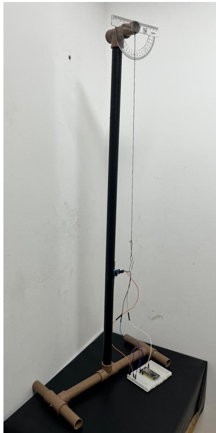
Figura 14: Aparato do experimento do pêndulo simples.
