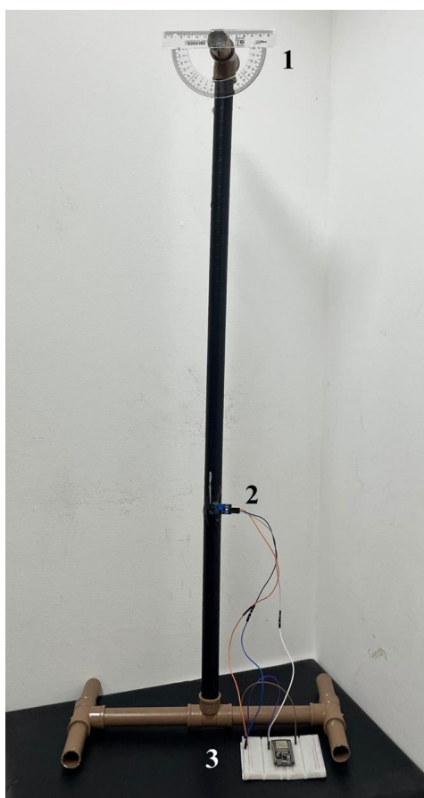
Figura 20: Estrutura desenvolvida para o experimento do pêndulo simples.
