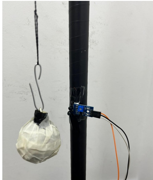
Figura 22: Estrutura do experimento com foco na posição do sensor e do peso do pêndulo.
