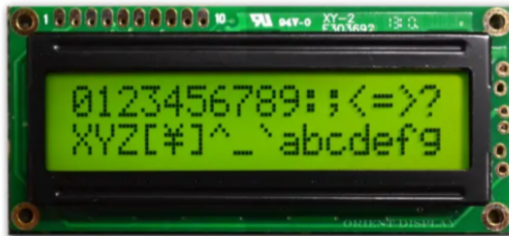
Figura 4: Display LCD 16x2. Fonte: Orient Display, 2022.
