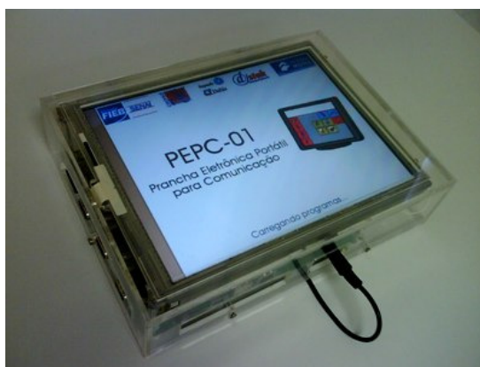
Figura 2. Protótipo de testes com kit de desenvolvimento AT91RM9200-EK.
