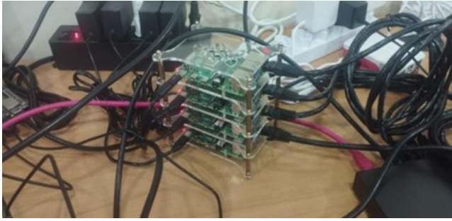
Figura 3. Estrutura do ClusterPi-4.
