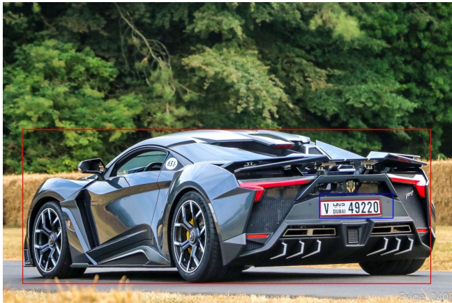
Figura 2. Exemplos de detecção de placas veiculares utilizando o método detectMultiScale com classificadores Haar Cascade sobre imagens dos conjuntos de dados utilizados nos experimentos. Fonte: Próprio autor e Conjunto de Dados.
