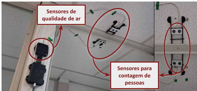
Figura 1. Dispositivo IoT do SAFE/UFRJ com seus sensores instalados na porta do LENS - Laboratório de Engenharia de Software
